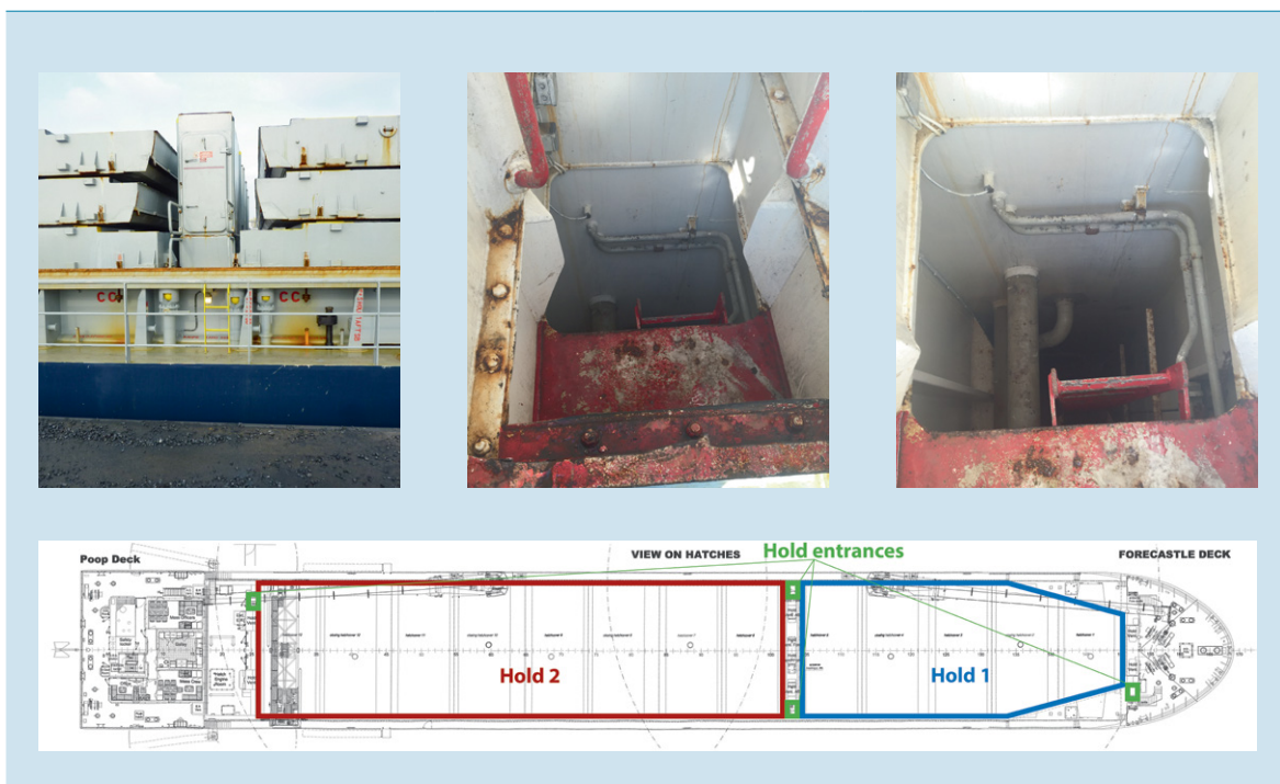
Figuur 1: Onder: indeling schip (hold = laadruim). Links boven: Toegang tot laadruimen midscheeps via portaal. Boven midden en rechts: Portaal zicht op trap naar beneden en plateau bovenaan trap. (Foto's: Onderzoeksraad voor Veiligheid)
