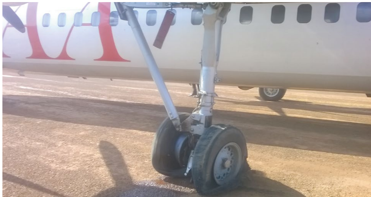
Positie van het linkerlandingsgestel na het voorval. (Foto: BPEA)
