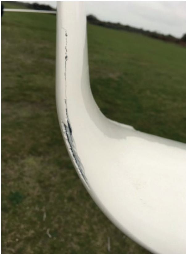
Schade aan de winglet van de D-KLEP. (Foto: gezagvoerder)
