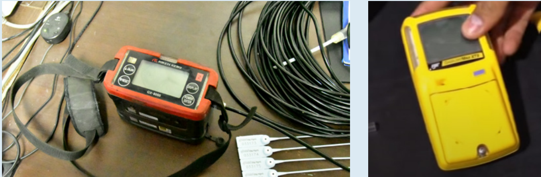
Figuur 8: foto links multi-gasmeter; foto rechts persoonlijke gecombineerde gasmeter.
