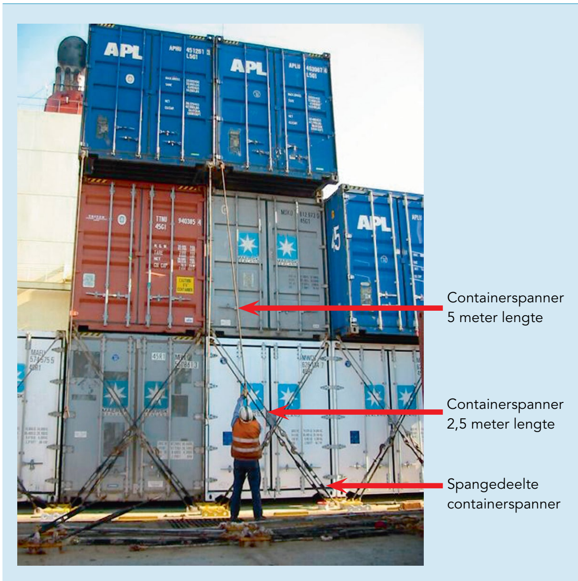
Figuur 1: Havenwerker bevestigt een 5 meter lange containerspanner. (Bron: www.portpictures.nl - Danny Cornelissen)
