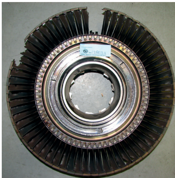
Schade aan eerste trap van hogedruk turbinebladen. (Bron: GRIAA CAA Colombia)
