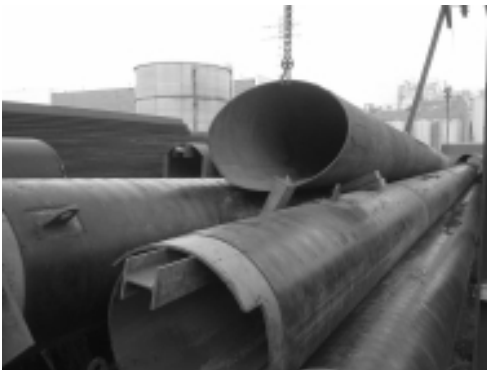
Een stempel valt als gevolg van onjuist toepassen van een hijsmiddel. Het effect bevindt zich in de BVZ.
