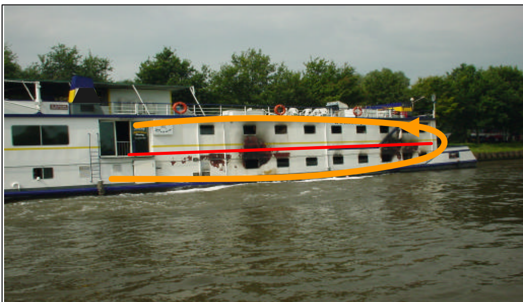
Figuur 4: Het stalen dek in rood, het verloop van de brand in oranje: brandverloop vanuit de machinekamer, over het onderdek met de hutten voor zowel de bemanning als passagiers, naar het middendek met uitsluitend hutten voor de passagiers (Bron: Onderzoeksraad).
