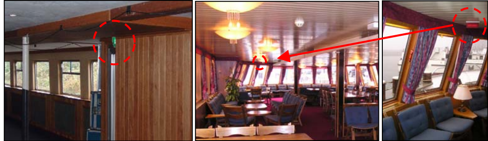
Figuur 14 Slecht zichtbare vluchtpictogrammen
