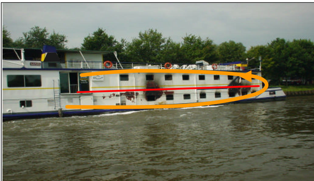
Figuur 9: Het stalen dek in rood, het verloop van de brand in oranje: vanuit de machinekamer over het onderdek met de hutten voor de bemanning en passagiers naar het middendek met de hutten voor de passagiers.
