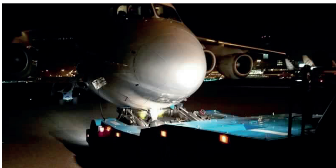
De EI-RJT en vliegtuigtrekker na de botsing. (Bron: Amsterdam Airport Schiphol)
