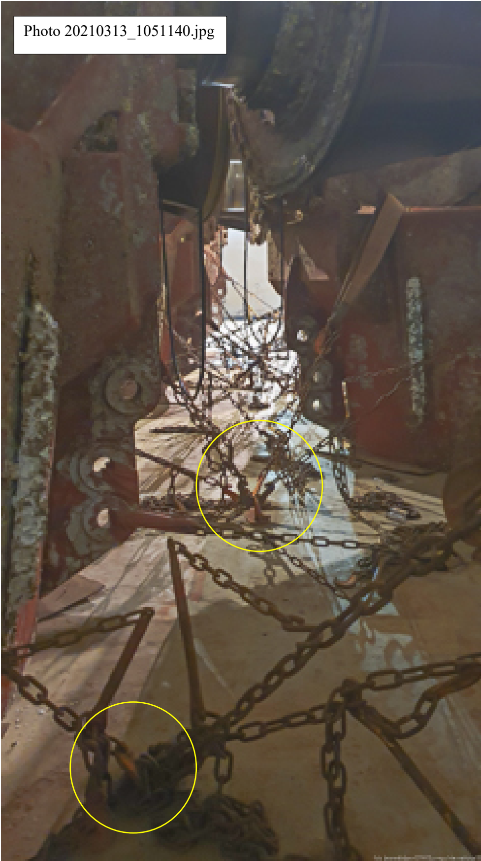
Vooraan 3 kettingen op één D-ring – 2 naar bakboord en één naar stuurboord Daarachter 2 kettingen op een D-ring, één naar bakboord en één naar stuurboord
