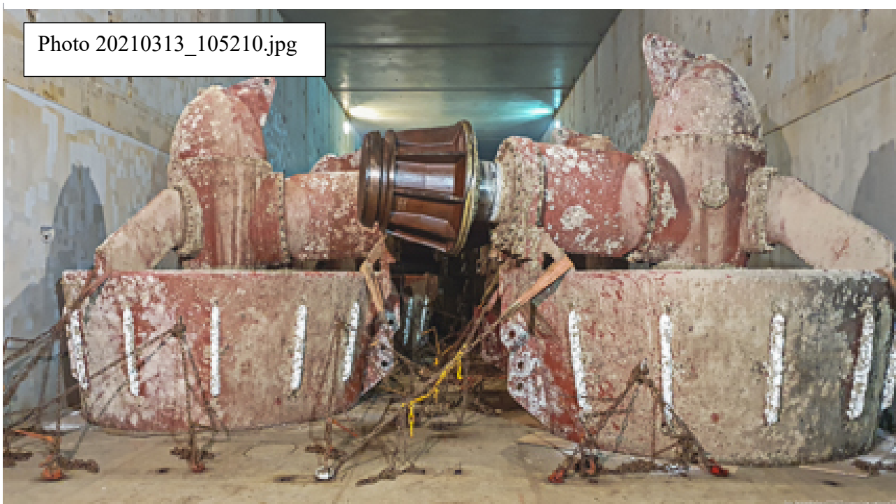
Voorste twee thrusters in het ruim (kijkend naar achterschip) Lijn met twistlock sockets zichtbaar. Standen van diverse sjorringen zichtbaar. Sjorringen op steunarmen van de straalbuizen met polyester voorloop
