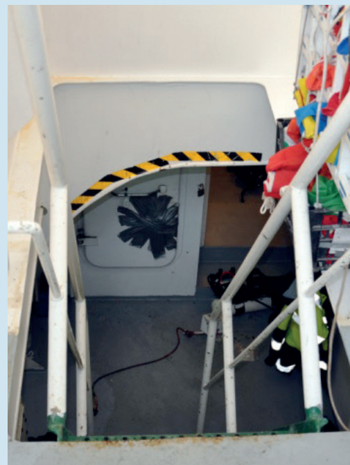
Figuur 3: Toegangstrap naar de bak en toegangsdeur naar de schacht van het ruim. (Bron: Onderzoeksraad voor Veiligheid)
