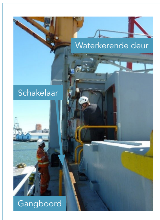
Figuur 10: Op deze foto is te zien dat iemand die uit de ruimtoegang midscheeps stapt, zich vlakbij het rijgebied van de luikenwagen bevindt.
