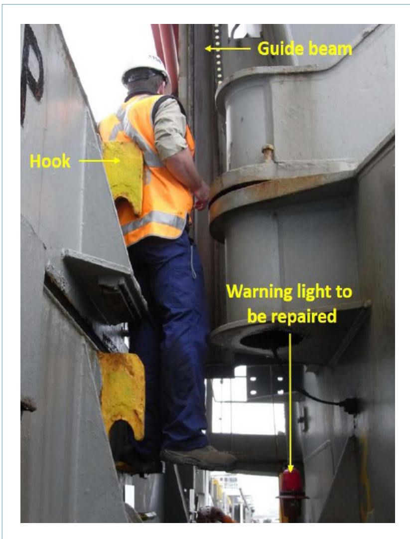
Figuur 12: Reconstructie van het voorval, het slachtoffer stond waarschijnlijk op een ladder van de gestapelde luiken. (Bron: ATSB)
