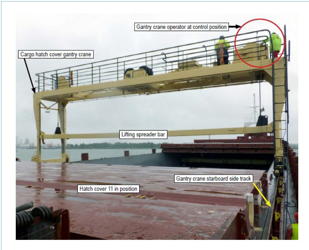
Figuur 18: Luikenwagen van de Cimbris (foto genomen vanaf stuurboord, gericht op de voorkant van het schip). (Bron: MAIB)
