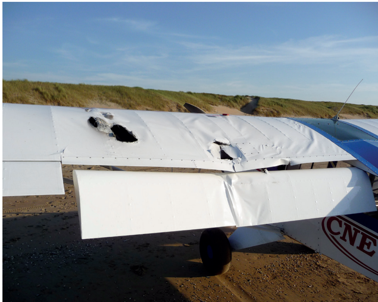
Schade aan PH-PHX na landing op strand
