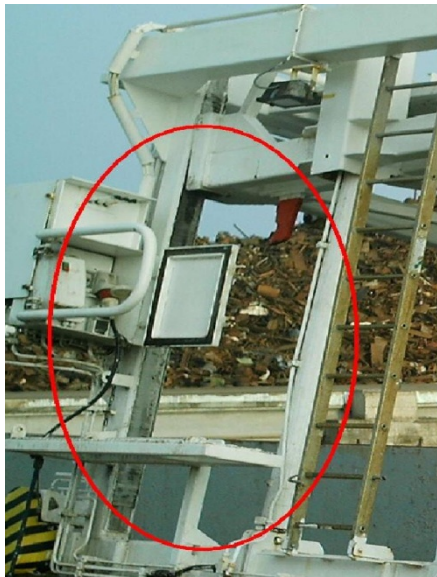
Foto 8: Beperkte valbeveiliging op het bedieningsplateau met een "open" deur (zie ook foto 3)
