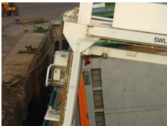
Foto 6: Kromme haken aan bakboordzijde
