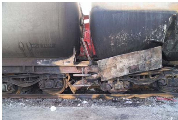
Afbeelding: Uitgebrande ketelwagon met geknikte draagbalk.
