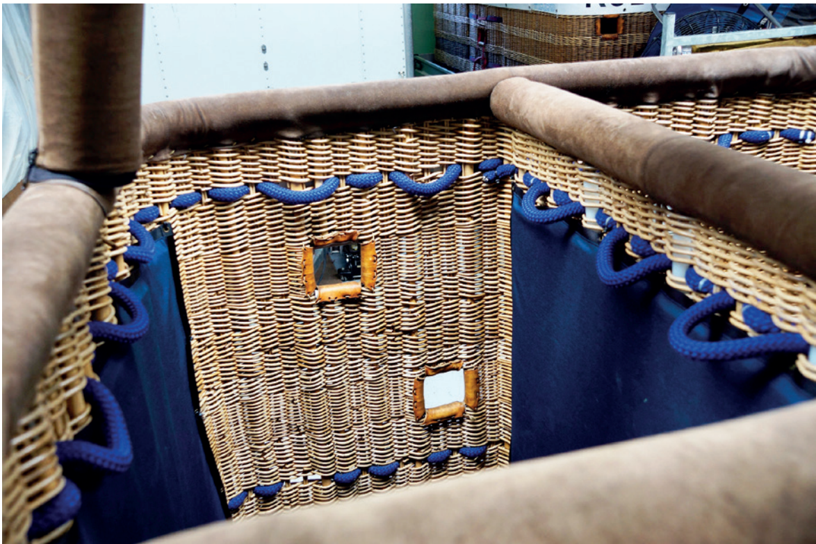
Figuur 3: Touwlussen aan de binnenkant van de mand. (Bron: Onderzoeksraad voor Veiligheid)
