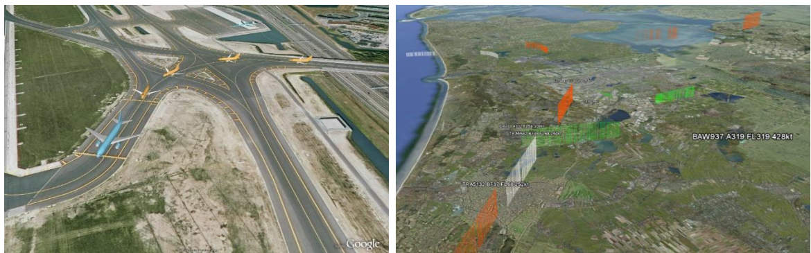
Figuur 2-1 - Met ADS-B kan zowel verkeer op de grond als in de lucht worden gevolgd
