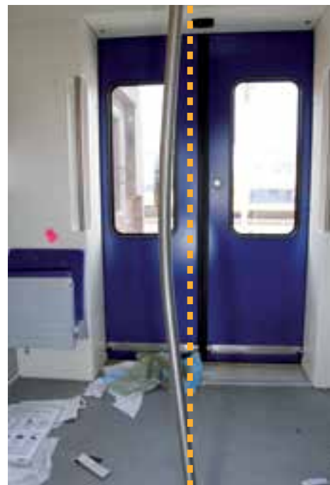
Figuur 20: Boven: de onbeschadigde tafel op de plaats waar de passagier in de intercity het fatale letsel opliep. Onder links: een omlaag geklapt tafeltje aan de achterzijde van een stoel van de intercity. Onder rechts: een verbogen stang op het balkon van de sprinter, vermoedelijk door contact met een passagier. Foto's: Onderzoeksraad voor Veiligheid.
