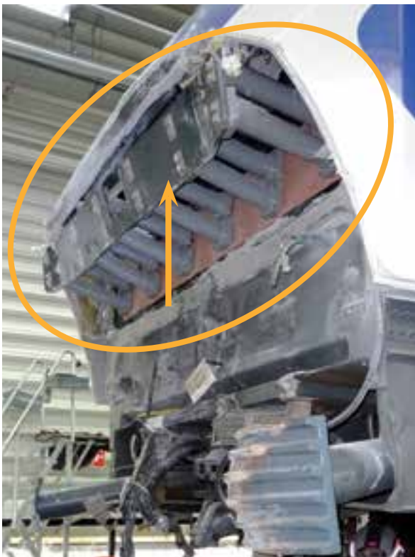
Figuur 14: Beide foto's tonen de verbogen crash-absorbers van de sprinter (foto onder: na volledig verwijderen kunststof neus). Foto's: Onderzoeksraad voor Veiligheid.
