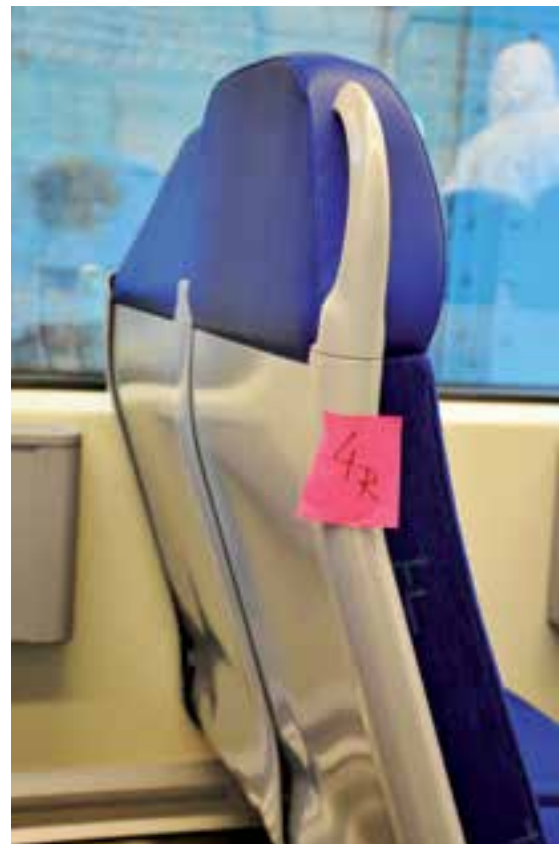
Figuur 11b: Boven links: afgebroken bevestiging sponning, rechts: vervormde stang voor houvast. Onder links: glazen wand, rechts: vervormde stoelen. Foto's: Onderzoeksraad voor Veiligheid.
