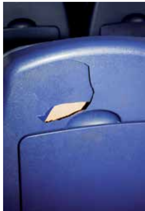
Figuur 10: Boven: beschadigde uiteinden van rijtuigen. Onder links: vervormde stoel, rechts: beschadigde stoel. Foto's: Onderzoeksraad voor Veiligheid.
