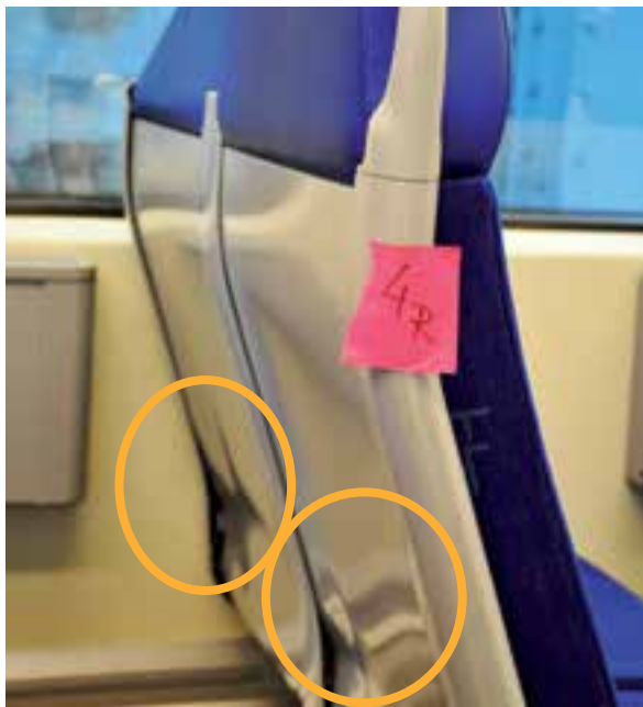
Figuur 19: Schade aan het interieur van de intercity en de sprinter. Boven links: gebroken plastic aan de achterzijde van de stoelen in de intercity ter hoogte van het hoofd. Boven rechts: gebroken plastic aan de achterzijde van stoelen van de intercity ter hoogte van de knieën. Onder: schade aan de achterzijde van de stoelen van de sprinter opgesteld in rijen achter elkaar. Foto's: Onderzoeksraad voor Veiligheid.
