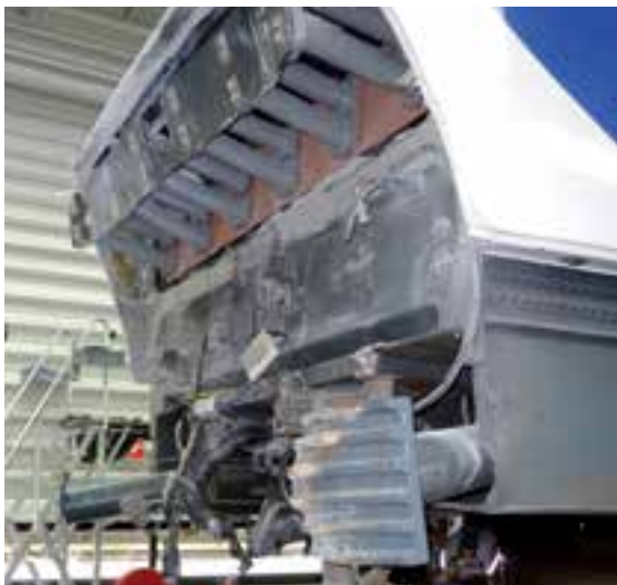
Figuur 11a: Boven links: beschadigde cabine sprinter, rechts: beschadigd front van de sprinter. Onder: idem na volledig verwijderen kunststof neus. Foto's: Onderzoeksraad voor Veiligheid.
