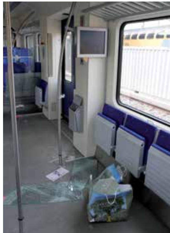
Figuur 21: Glasschade. Boven links: toegang reizigerscompartiment intercity. Boven rechts: gebroken glazen scheidingswand sprinter. Onder links: verbrokkelde glazen deur sprinter. Onder rechts: gebroken en losgeraakte glasscherven sprinter. Foto's: Onderzoeksraad voor Veiligheid.
