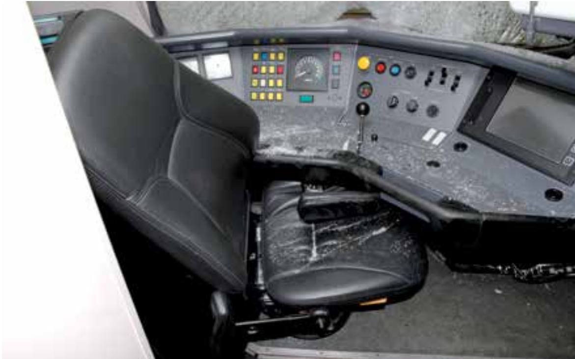
Figuur 15: Ingeschoven stuurtafel intercity. Foto: Onderzoeksraad voor Veiligheid.
