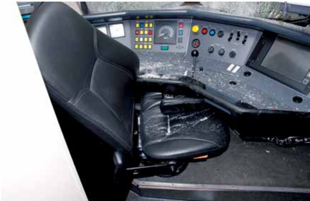
Figuur 9: Boven links: beschadigd front van intercity, rechts: de naar achteren verschoven airco. Onder: schade aan de stuurtafel. Foto's: Onderzoeksraad voor Veiligheid.
