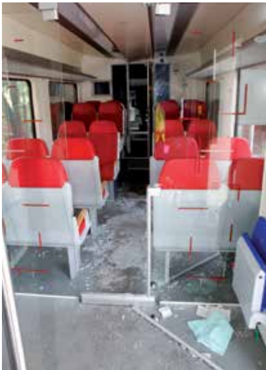
Figuur 21: Glasschade. Boven links: toegang reizigerscompartiment intercity. Boven rechts: gebroken glazen scheidingswand sprinter. Onder links: verbrokkelde glazen deur sprinter. Onder rechts: gebroken en losgeraakte glasscherven sprinter. Foto's: Onderzoeksraad voor Veiligheid.
