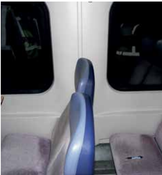
Figuur 10: Boven: beschadigde uiteinden van rijtuigen. Onder links: vervormde stoel, rechts: beschadigde stoel. Foto's: Onderzoeksraad voor Veiligheid.
