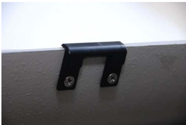
Figuur 10: verbeterde bevestigingsbeugel voor de passagiersdeur van de PH-TIN (bron: W.L. Nijdam)
