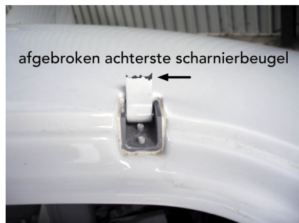
Figuur 5: afgebroken achterste scharnierbeugel (bron: Wings over Holland)
