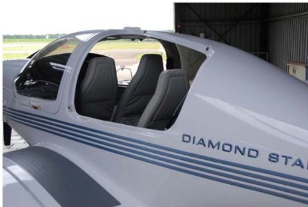
Figuur 2: passagiersdeur ontbreekt na de vlucht Figuur 3: afgebroken passagiersdeur (bron: W.L. Nijdam)
