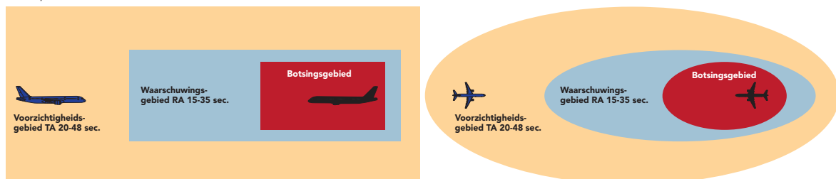
Figuur 9: Schematische weergave in het verticale en horizontale vlak met het gebied van 'Traffic Advisory' en 'Resolution Advisory' 23
