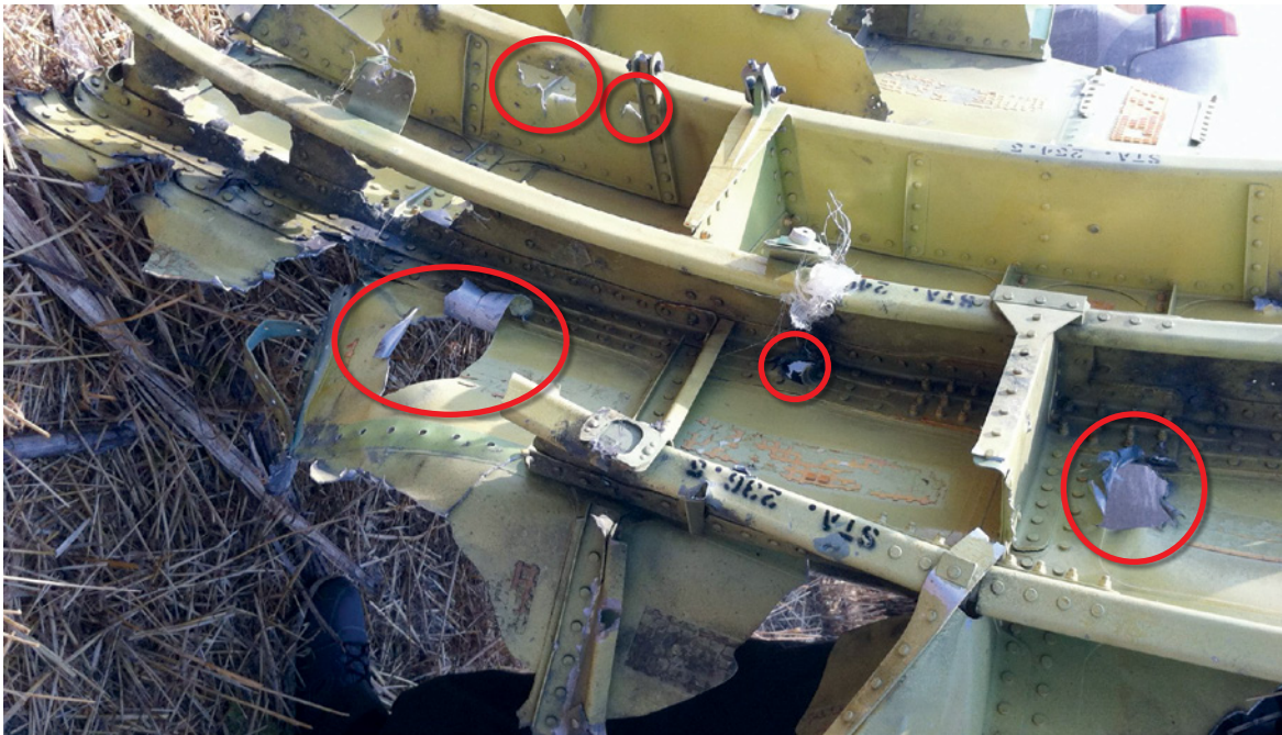
Figuur 9: Deel van de binnenkant van de romphuid van het cockpitdak, met tekenen van doorboring met voorwerpen van buitenaf. (Bron: DCA)
