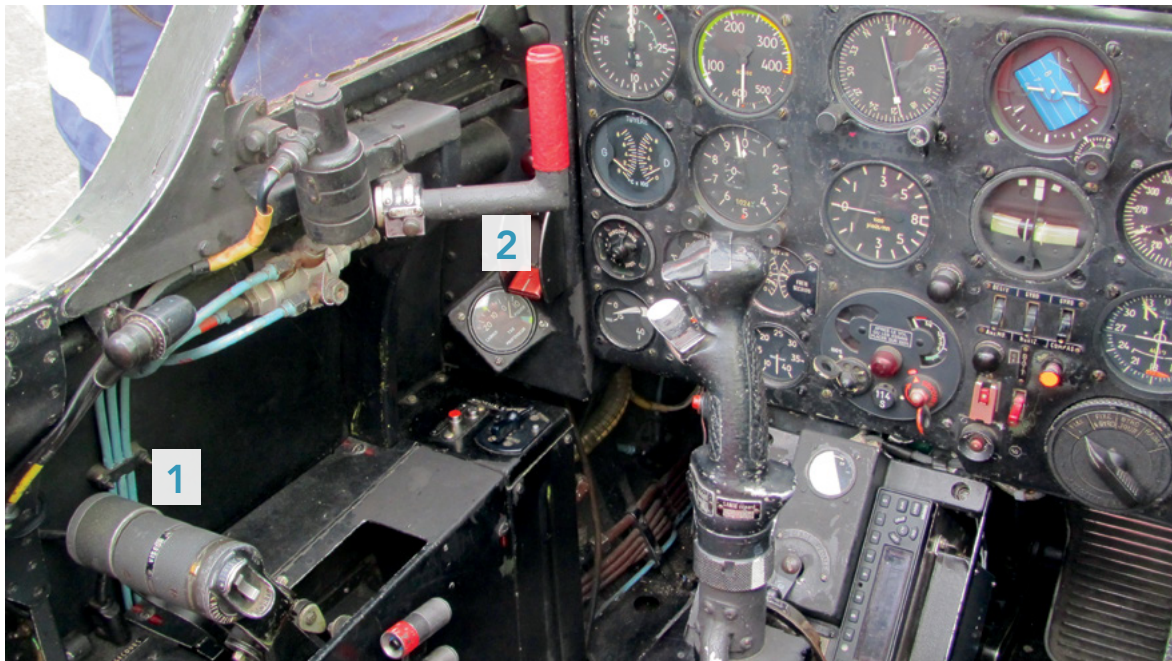
Figuur 2: De cockpit van de Fouga met de gashendel (1), en hendel van het landingsgestel (2). De hendel voor de bediening van de flaps bevindt zich achter en onder de gashendel. (Bron: Onderzoeksraad voor Veiligheid)
