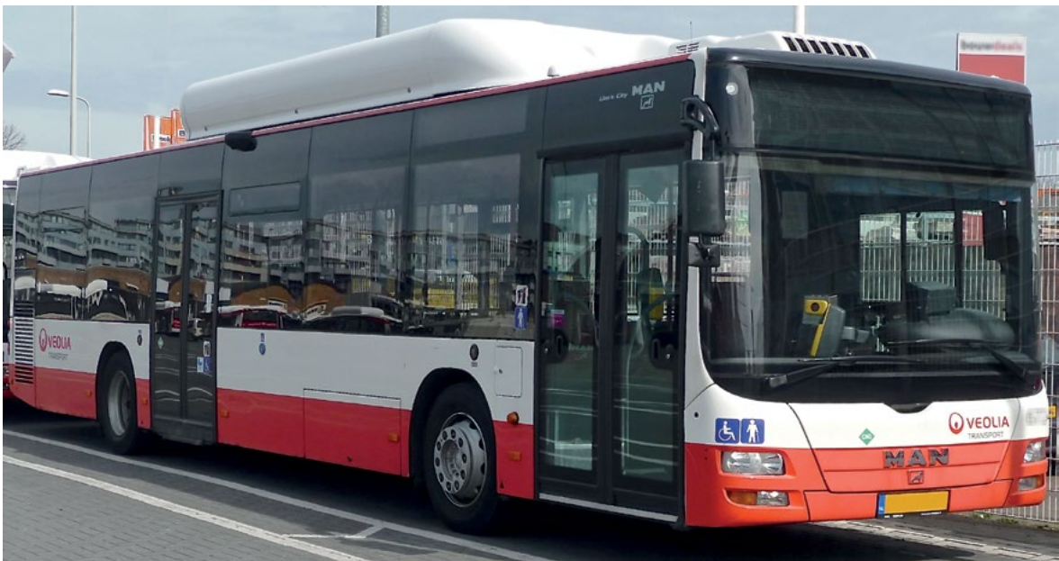
Figuur 1: MAN Lion's City bus op CNG (met op het dak de CNG-installatie)
