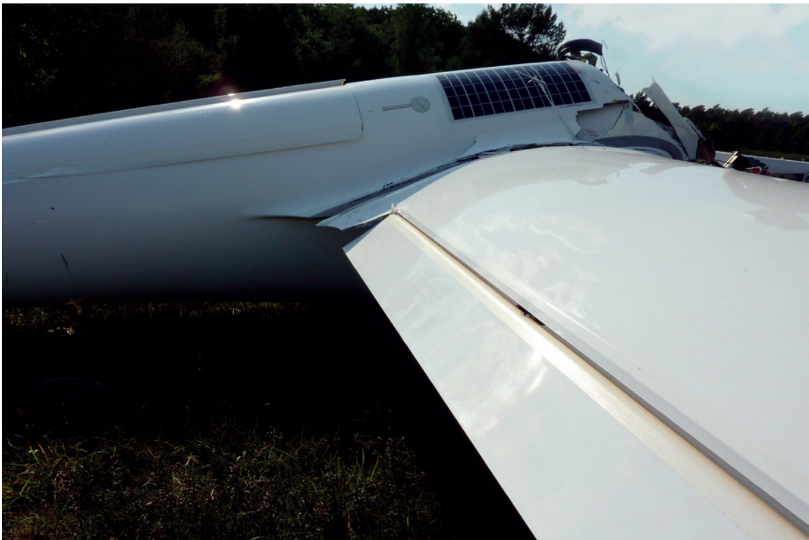
Figuur 2: Flapstand +8 graden van de rechtervleugel na het ongeval. (Bron: Onderzoeksraad voor veiligheid)
