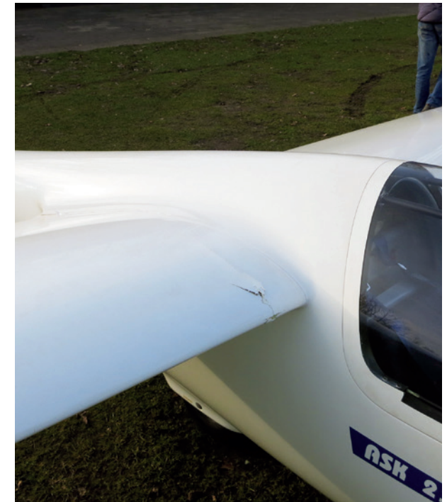
Schade aan rechtervleugel. (Bron: Kennemer Zweefvliegclub)
