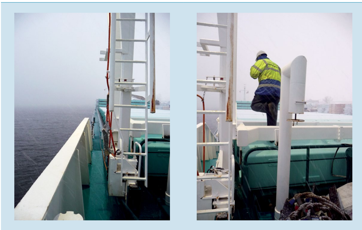
Figuur 5: De twee opties voor een passage naar het voorschip. Via het gangboord (L) of over de dekluiken (R). (Bron: Onderzoeksraad voor Veiligheid)
