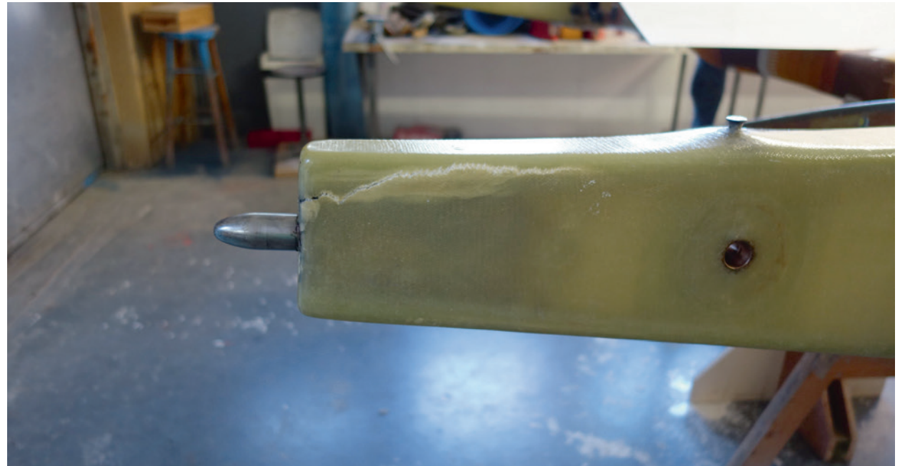
De scheur in de ligger van de linkervleugel van de PH-1006. (Foto: Zweefvliegclub)
