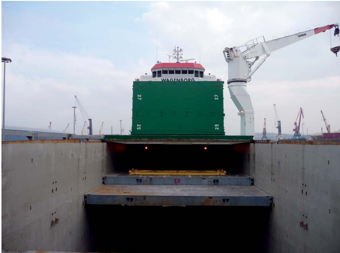
Figuur 2: Een tussendeck aan boord van de Azoresborg (ruim 2). (Bron: Onderzoeksraad voor Veiligheid)
