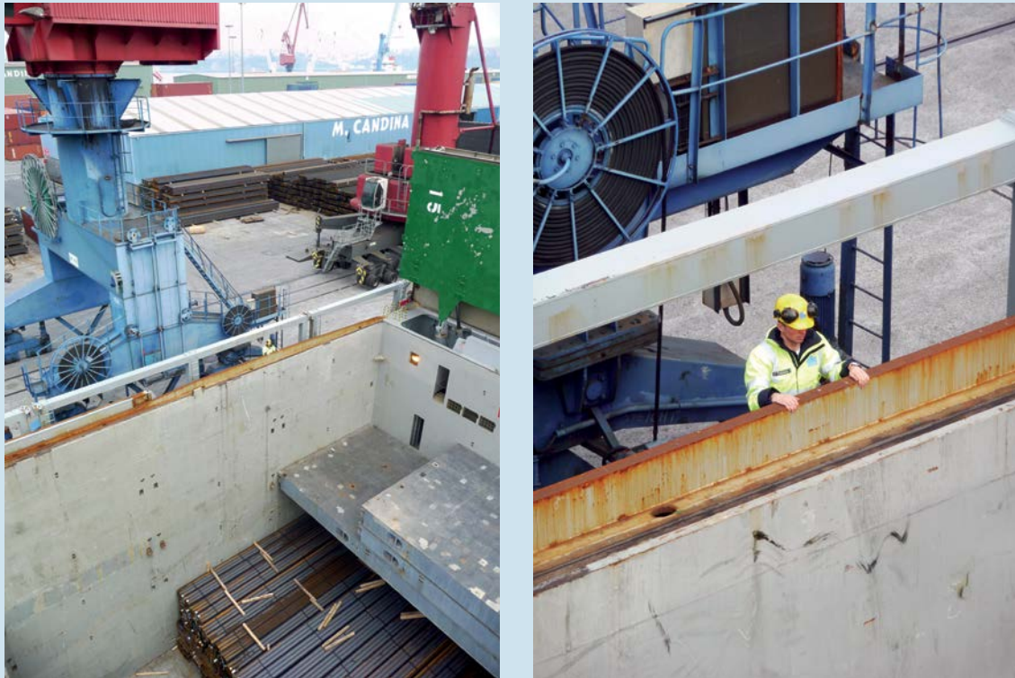
Figuur 6: Reconstructie - Positie eerste stuurman op ladder bij het luikhoofd. De persoon op de foto heeft een lengte die ongeveer gelijk is aan die van de verongelukte stuurman. (Bron: Onderzoeksraad voor Veiligheid)
