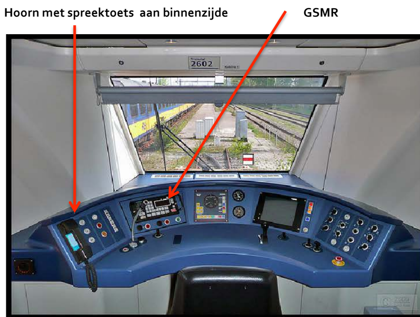
figuur 4 Plaatsing van de GSM-R apparatuur in de stuurtafel.
