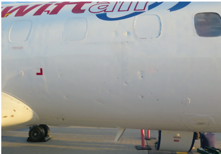
Schade aan de EC-JBD na de landing. (Foto: AAIB)
