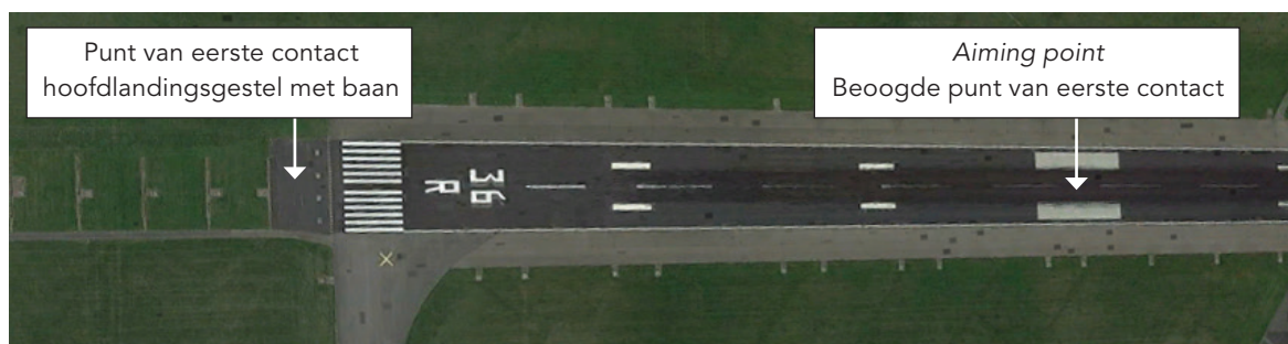
Figuur 2: Bovenaanzicht van het eerste stuk van landingsbaan 36R met daarbij aangegeven het daadwerkelijke punt van eerste contact en het beoogde punt van eerste contact. (Bron: Google Earth)
