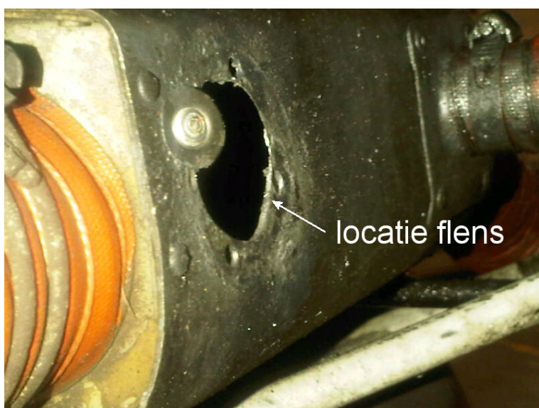
Figuur 3: mantel met de oorspronkelijke locatie van de afgebroken flens (bron: betrokken luchtvaartbedrijf)
