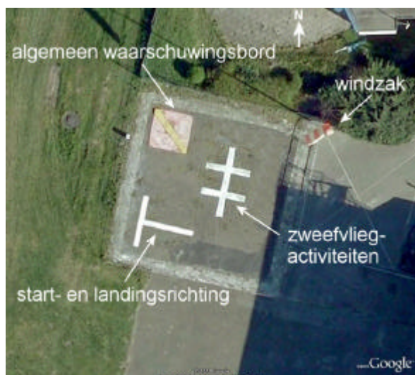
Figuur 2: seinenvierkant: tekens op de grond die zichtbaar zijn vanuit de lucht met daarin onder andere de in gebruik zijnde landingsrichting
