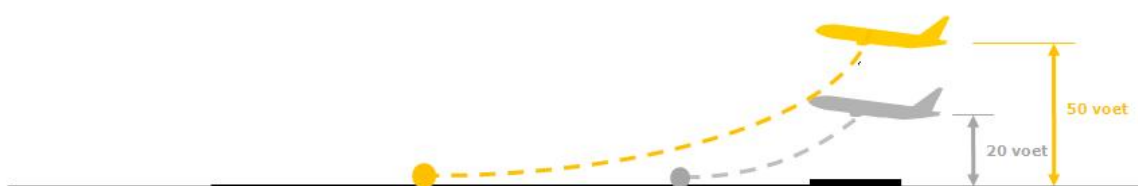
Figuur 4: schematische weergave van de afvangmanoeuvre (flare) op 20 voet (grijs) en de afvangmanoeuvre op 50 voet (geel) met het daarbij behorende landingspunt op de baan
