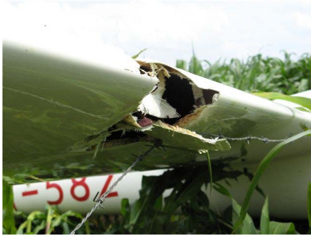
Afbeelding 2: Schade aan rechtersvleugel
