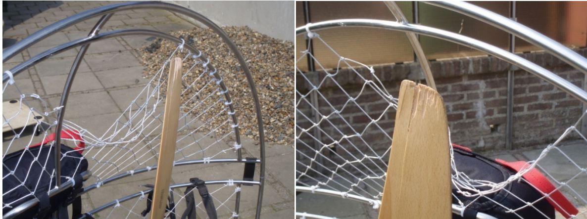
Figuur 1 en 2: detailschade propeller en net PH-9E9 na het ongeval (bron: eigenaar)
