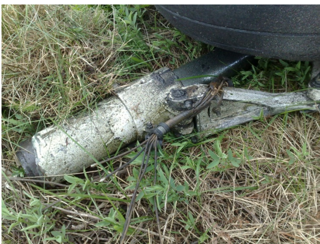
Figuur 2: de bezweken buitenste buis van het linkerhoofdlandingsgestel
