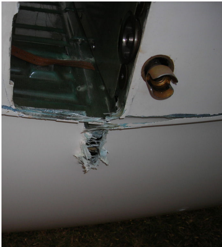
Figuur 1: schade aan de linkerkant van de romp
