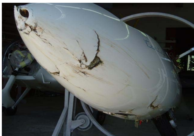
Illustratie 1: schade aan de voorzijde van de romp
