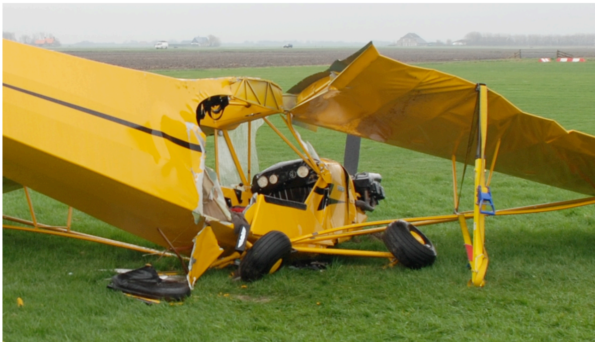
Foto 2: Detail schade aan het vliegtuig: afgebroken vleugelbevestiging en landingsgestel
