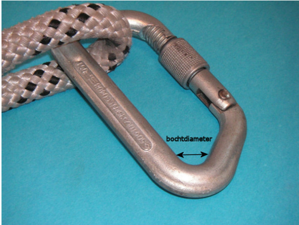
Afbeelding 4: gebruikte karabijnhaak aan de ankerlijn
