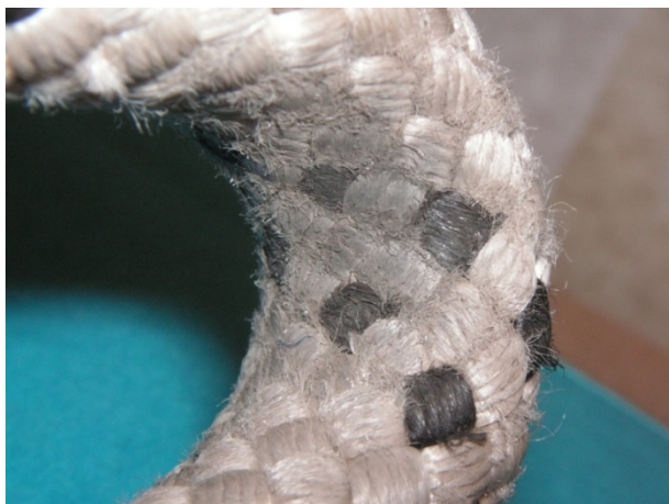
Afbeelding 3: samengedrukte lus van de ankerlijn
