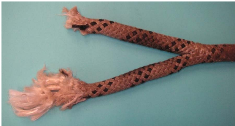
Afbeelding 2: gebroken lus van de ankerlijn
