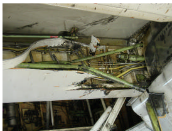
Figuur 2: Beschadigde delen van het flapsysteem
