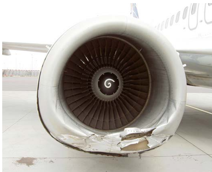
Figuur 2: De schade aan de motorgondel
