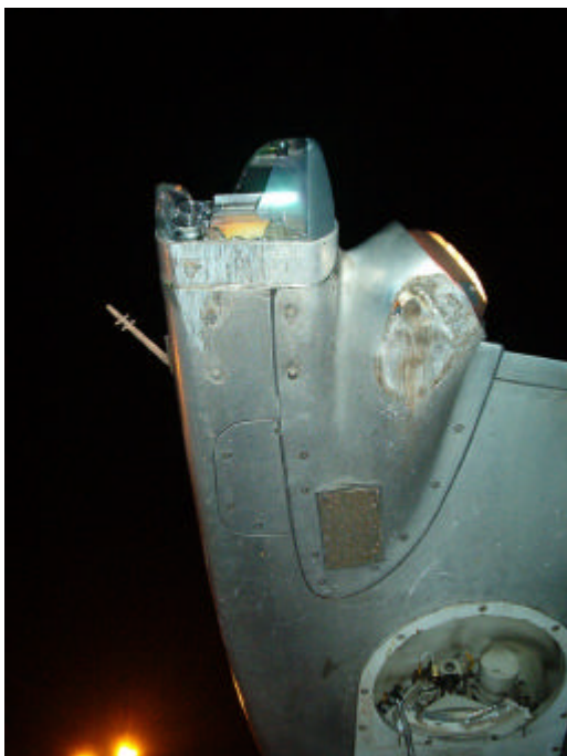
Afbeelding 1: Schade aan de linker vleugeltip
