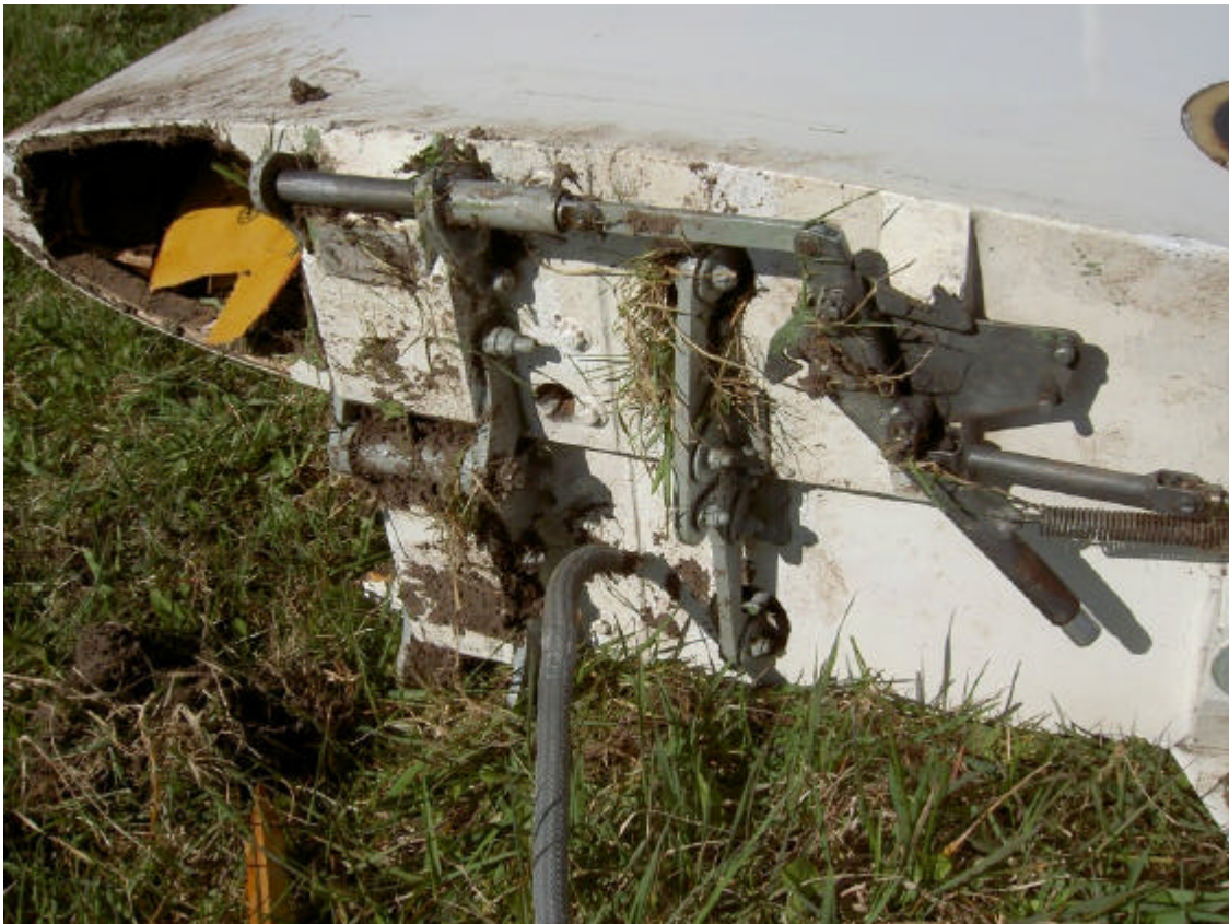
Figuur 1. Borgpen en bedieningshendel in de geborgde positie, de ogen van het buitenste vleugeldeel onbeschadigd in de grond gedrukt.
