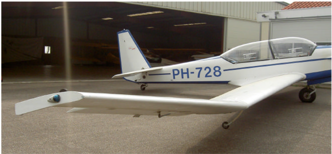
Figuur 3. Duidelijk waarneembare hoek tussen het vaste- en buitenste vleugeldeel wanneer deze niet juist is geborgd.
