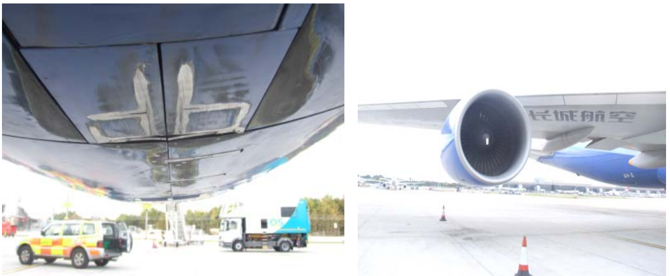
Figuur 1: schade aan de onderzijde van de rechter buitenmotor 4
