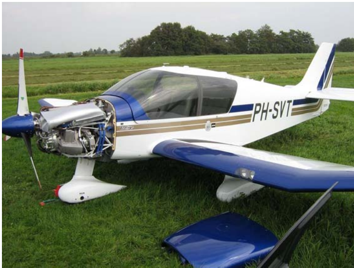
Figuur 1: PH-SVT na de noodlanding met de motorkap verwijderd voor onderzoek
