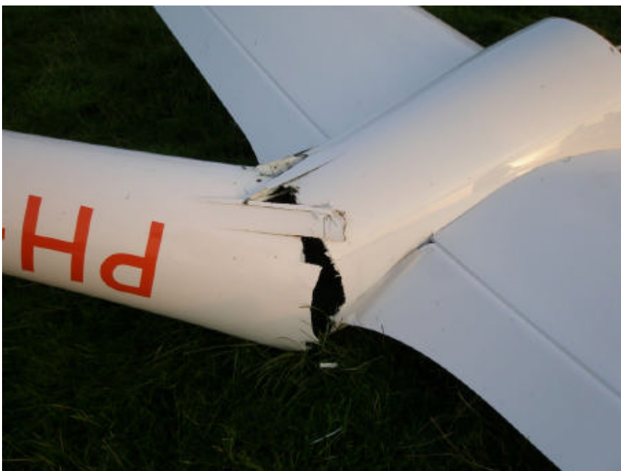
Foto 2: Detail schade aan het vliegtuig – gebroken romp
