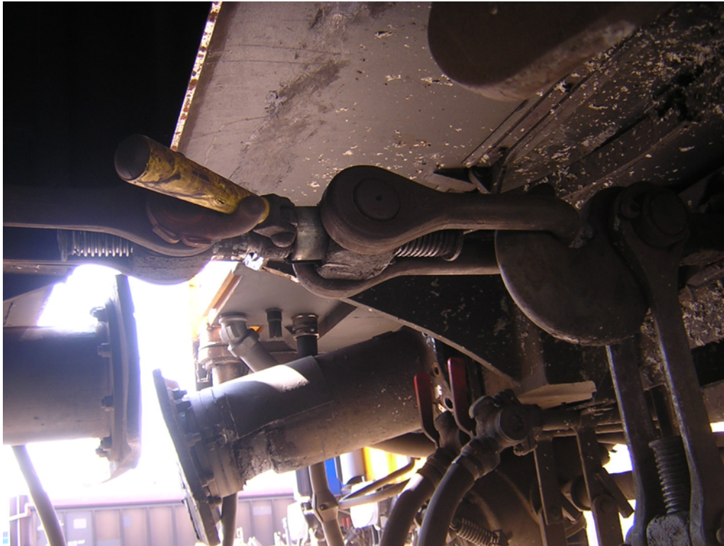
Afbeelding 8. Situatie van het linkerbufferpaar na de ontsporing
