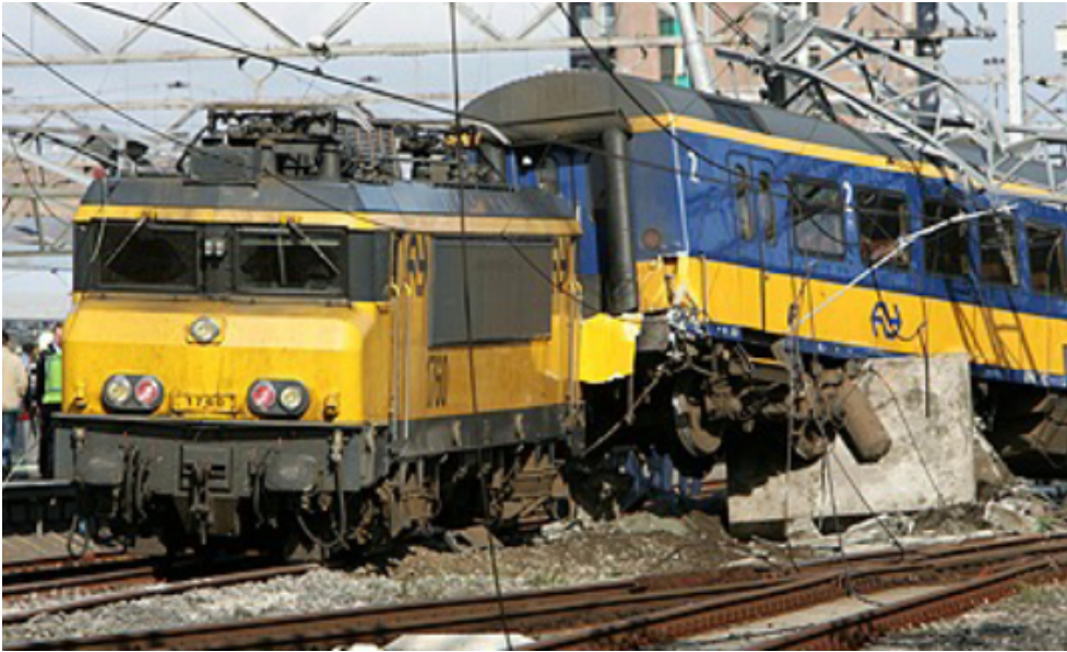
Afbeelding 4. Schade aan en eindpositie van de trein.
