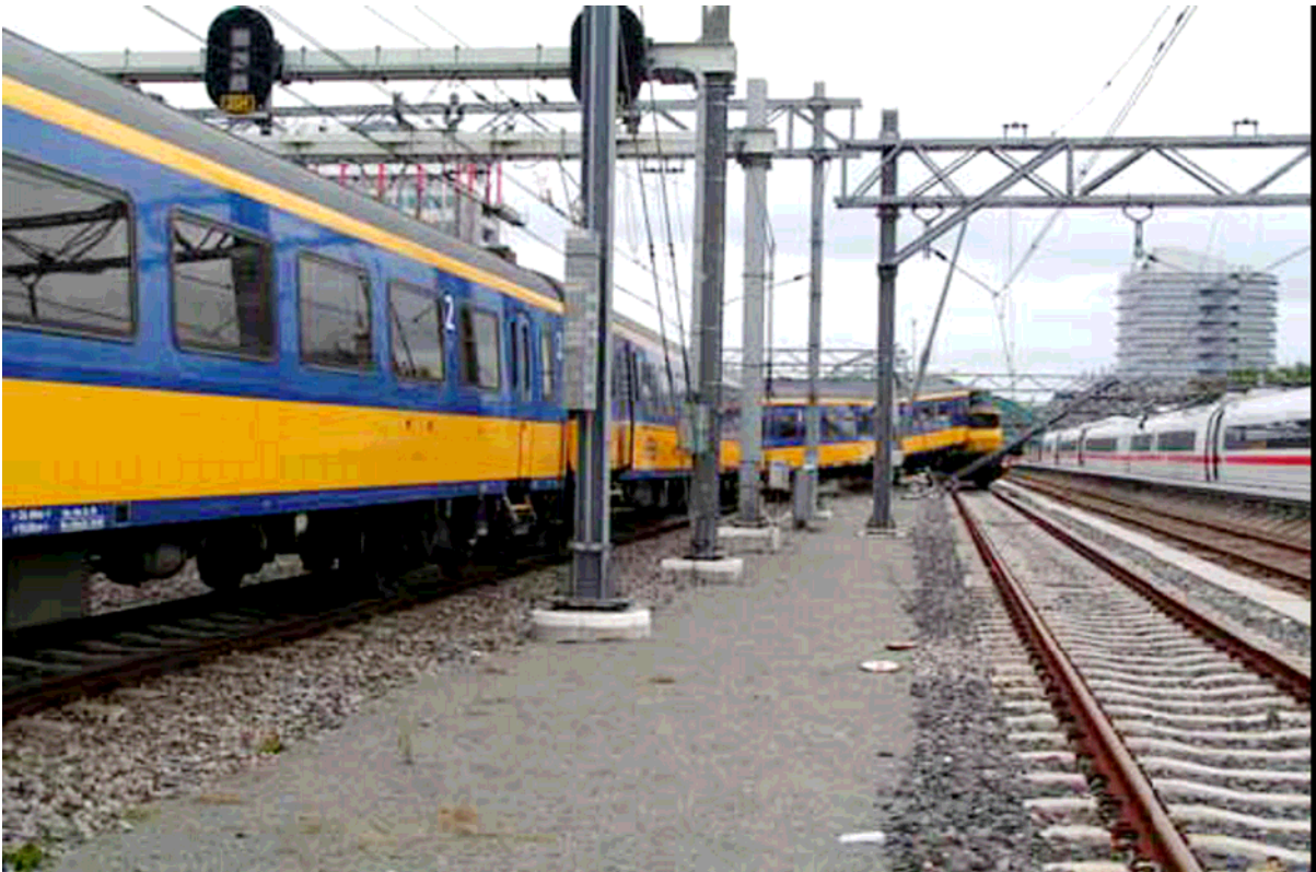
Afbeelding 1. De locomotief komt op spoor 26 tot stilstand (hier gezien tegen rijrichting in). Het laatste rijtuig staat tussen twee sporen in (Bron: Inspectie VenW).
