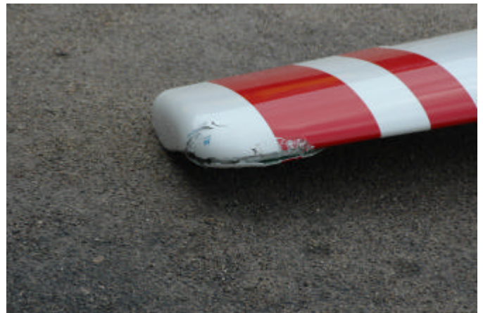
De beschadigde neus en rechtervleugeltip van de PH-1334 (Bron: KLPD).
