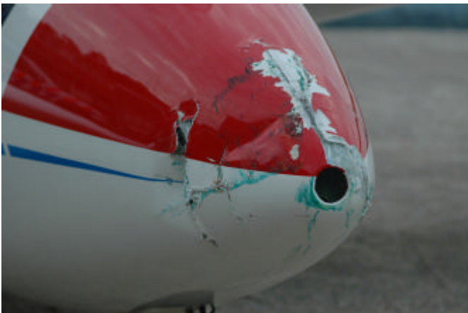
De beschadigde neus en rechtervleugeltip van de PH-1334 (Bron: KLPD).
